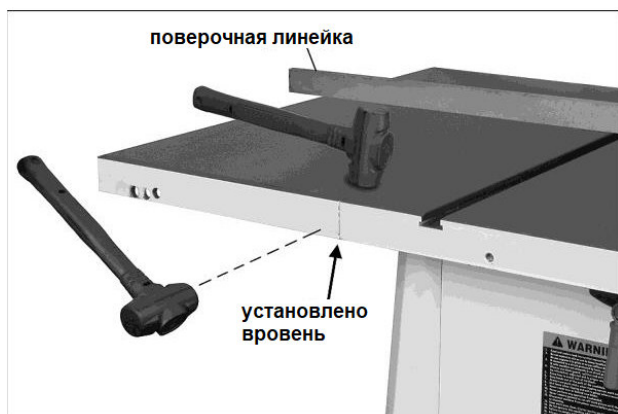
Рис. 5-5: выравнивание удлинений стола, способ 1
